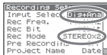
\* Si **Rec Freq** se configura **192 kHz** tras seleccionar **Dig+Ana**, **Input Select** cambiará automáticamente a **Digital**, y **Rec Mode** a **STEREOx1**.
